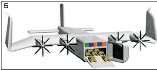
Схема загрузки и размещения полезной нагрузки в грузовых отсеках экранолета «Пеликан»: А – стандартных морских контейнеров; Б – вооружения и военной техники
